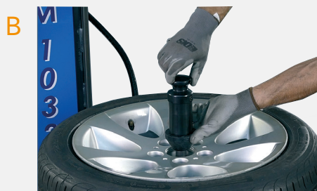
POSIZIONAMENTO MANIGLIA CON CONO SUL CERCHIO
