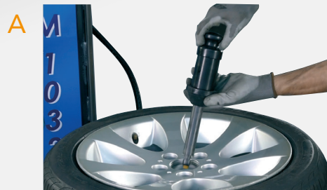
INSERIMENTO MANIGLIA CON CONO DI BLOCCAGGIO
